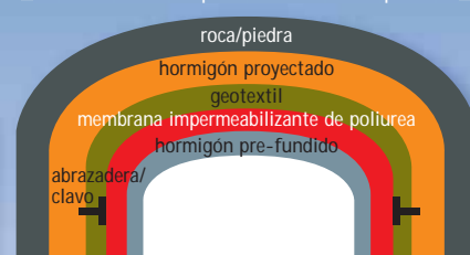
III. 2b: Túnel principal – con membrana impermeabilizante de poliurea
