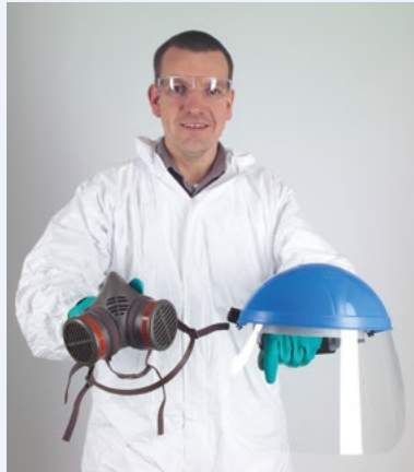
Spezielle Schutzausrüstung für die Anwendung in schlecht belüfteten Räumen und unter Druck (z. B. Verpressen von Injektionsharzen)
