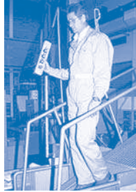
Abb. 2: Prüfverfahren „Schiefe Ebene“ [1]
