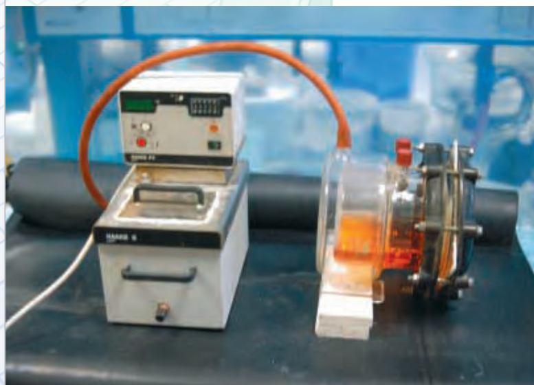
Abb. 12: Prüfung von Korrosionsschutzwerkstoffen in einer Atlaszelle
