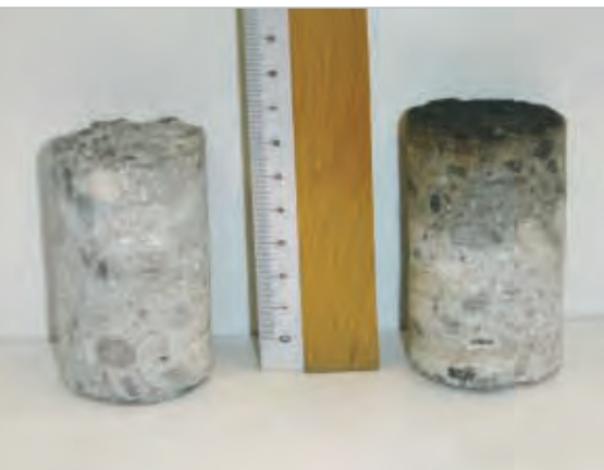
Abb. 11: Eindringen von Ölen in Beton
