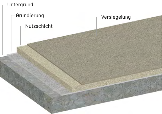
Abbildung 9: Beispiel für den Systemaufbau OS 11b
