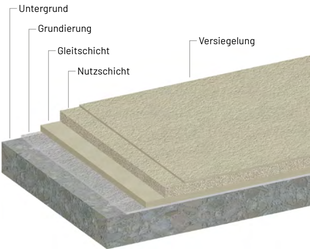
Abbildung 8: Beispiel für den Systemaufbau OS 11a
